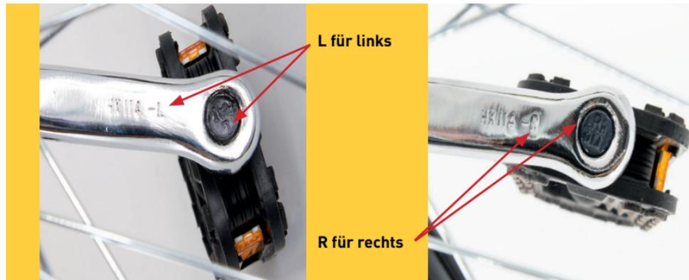
Das linke Bild zeigt also die linke Kurbelinnenseite - mit dem „L“, das rechte Bild die rechte Kurbelinnenseite mit dem „R“. Hier auf dem Bild sind auch schon die Pedale eingedreht - auf deren Achsinnenseite auch schon ein „L“ bzw. „R“ zu erkennen sind.
