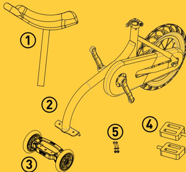
(1) Sattel samt montierter Sattelstütze, Griff vorn
